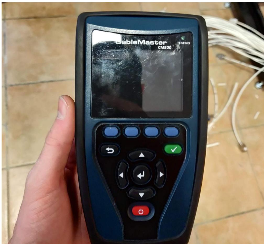
Tout d'abord il faut vérifier que le dispositif de test fonctionne correctement en le testant "à vide"
